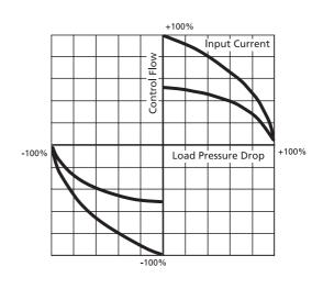
■Supply Pressure: ——— 21MPa ———14MPa ———7MPa ———3.5MPa
